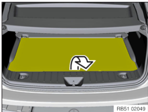
5. Снять облицовку багажного отделения.
