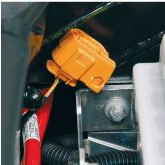
Высоковольтное аварийное место разъединения закрыто.
