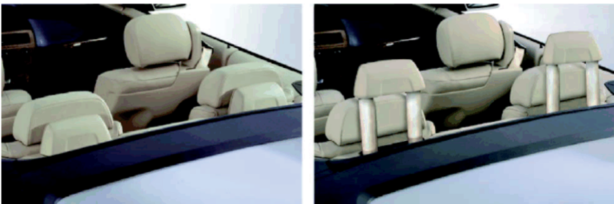
Защита при переворачивании у 6-й серии E64 в нормальном положении и сработавшая (справа)
