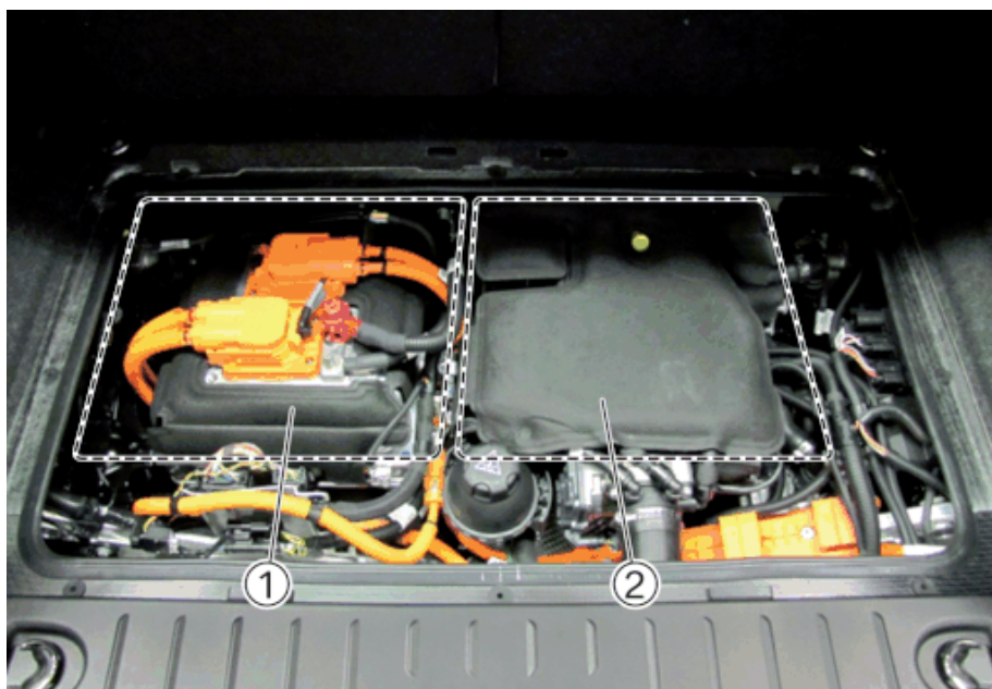
Под отверстием слева находится электромашинная электроника (1) с расположенной ниже электромашинной, а справа размещен усилитель диапазона (2) (если установлен).
